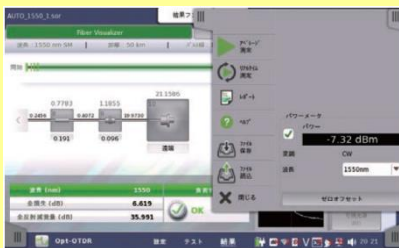
<OTDRと光パワーメータの同時使用>
